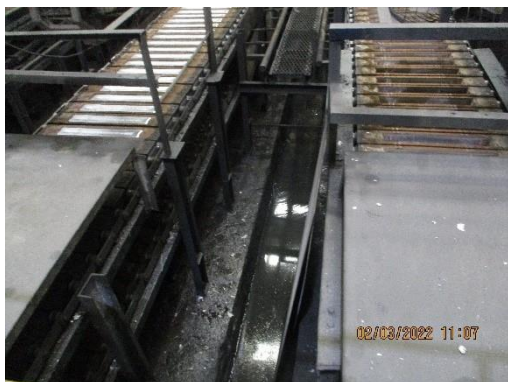
รูปที่ 9 รางรองรับน้ำเสียจากระบบหล่อเย็นแม่พิมพ์อลูมิเนียมอินกอท
