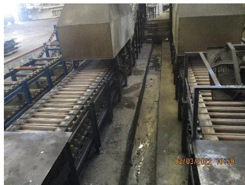
รูปที่ 9 รางรองรับน้ำเสียจากระบบหล่อเย็นแม่พิมพ์อลูมิเนียมอินกอท
